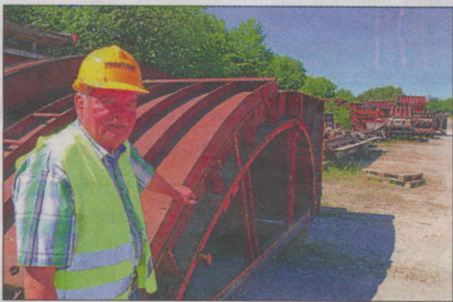
Niels Christian Halleløv har støbeforme i lange baner klar, både til firkanttunneler og, som her, buetunneler.
