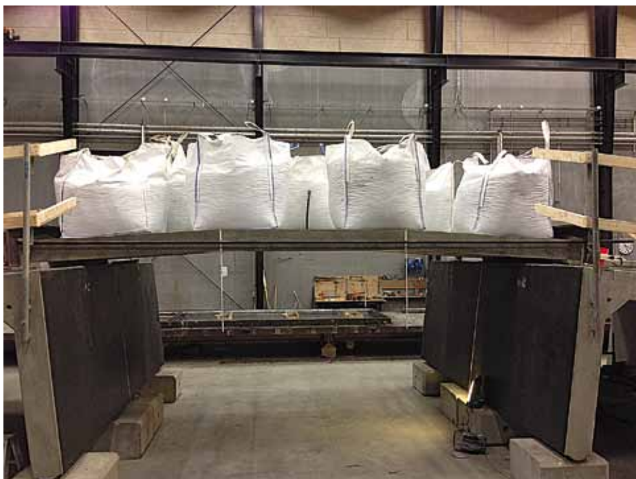
Figur 2. Testbro I belastes med 7x1 ton stenfyldte sække.
